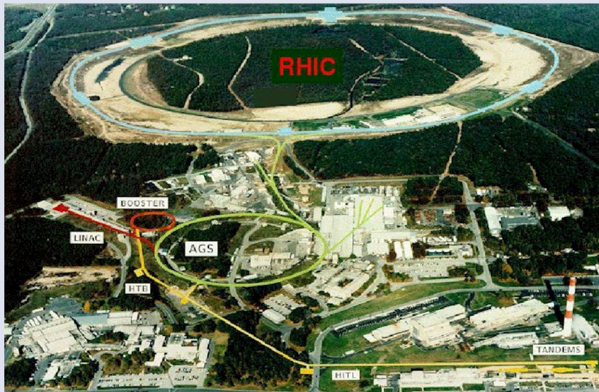
Коллайдер RHIC находится в Брукхейвенской национальной лаборатории (США) представляет собой туннель длиной 3.8 км, в котором расположены два идентичных кольца сверхпроводящих магнитов с шестью точками пересечений. В четырех точках находятся экспериментальные установки STAR, PHENIX, BRAHMS и PHOBOS. На коллайдере ускоряются ядра (протоны) с максимальной энергией 100 (250) ГэВ на нуклон.
